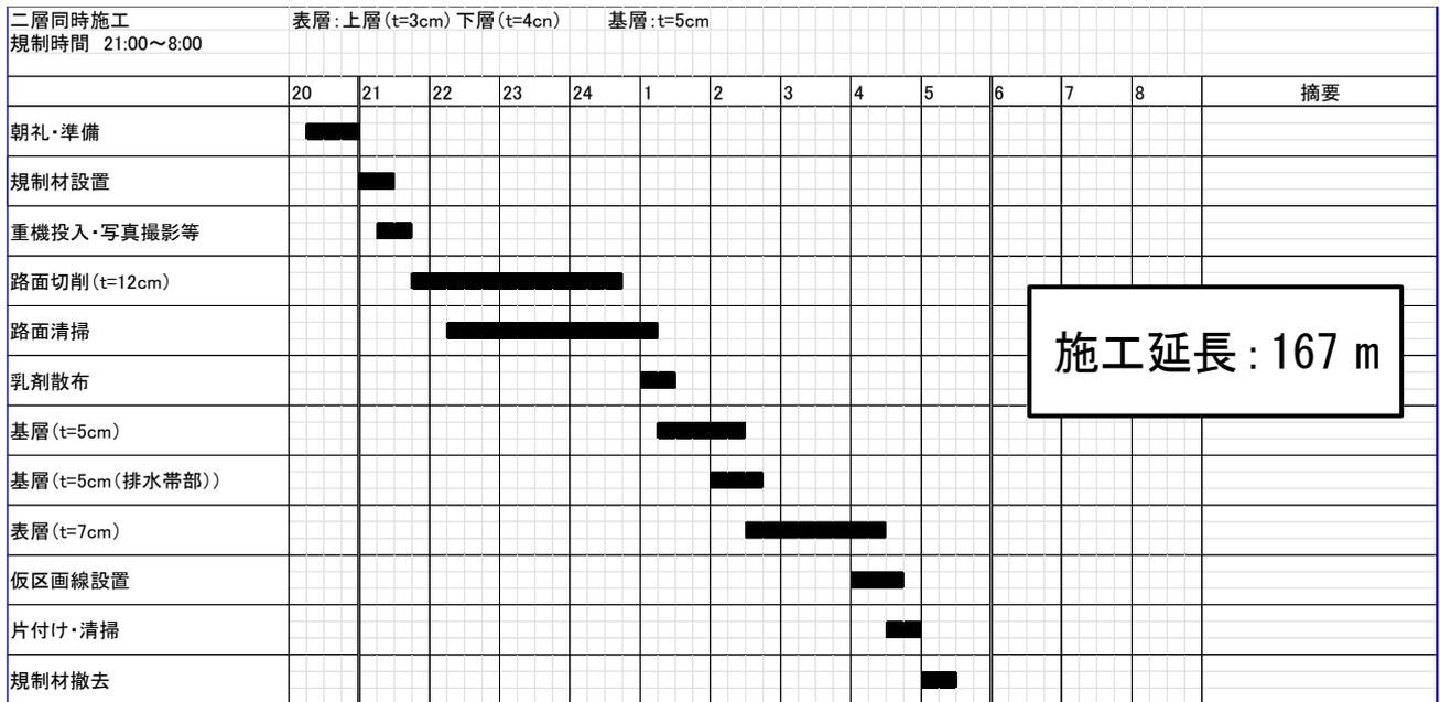
図 13 二層同時施工の施工時間割（案）
