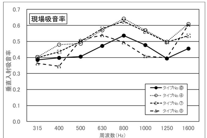
図10 垂直入射吸音率 (現場試験)
