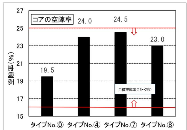
図 7 空隙率測定結果
