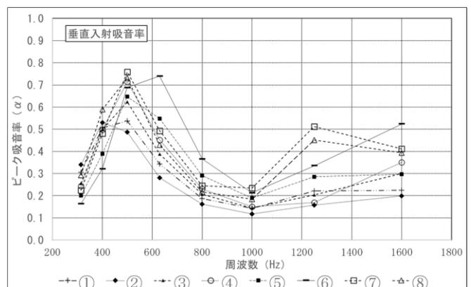
図4 垂直入射吸音率測定結果
