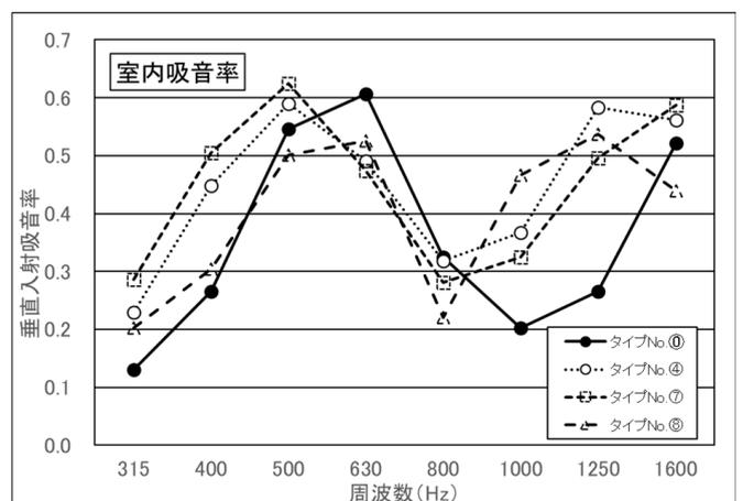
図11 垂直入射吸音率 (現場試験)
