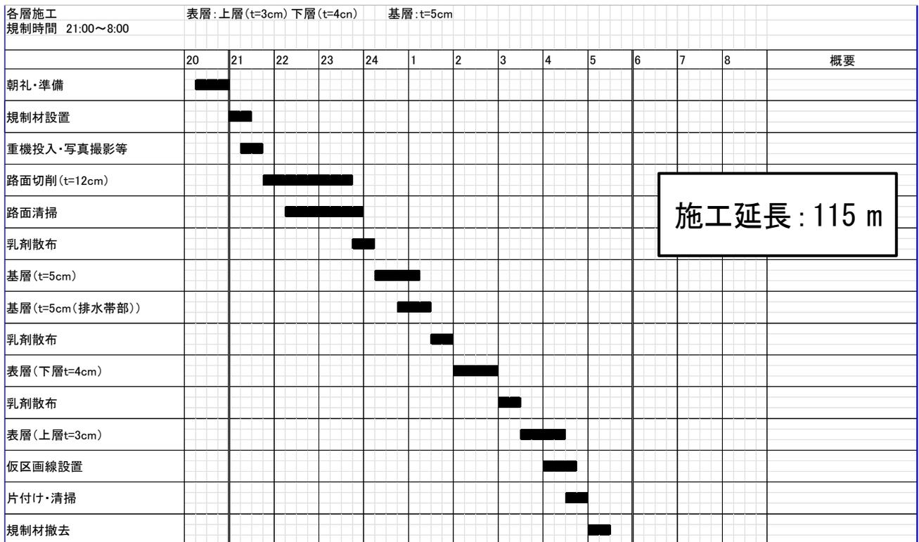
図 14 各層施工の施工時間割（案）
