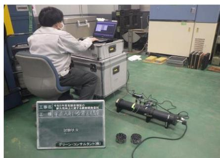
写真-1 吸音率試験（令和5年度室内試験）
