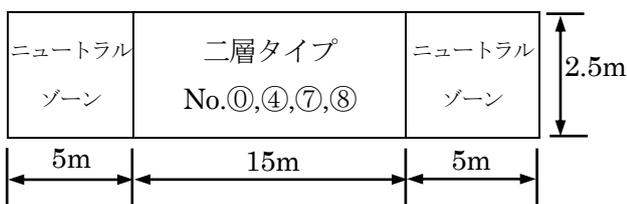
図 6 場内試験路面の施工規模
