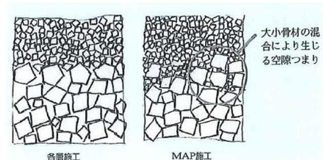
図5 MAPによる施工と各層施工により敷設した二層式低騒音舗装の断面構造の違い<sup>3)</sup>
