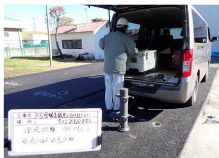
写真-2 吸音率試験（令和6年度現場試験）
