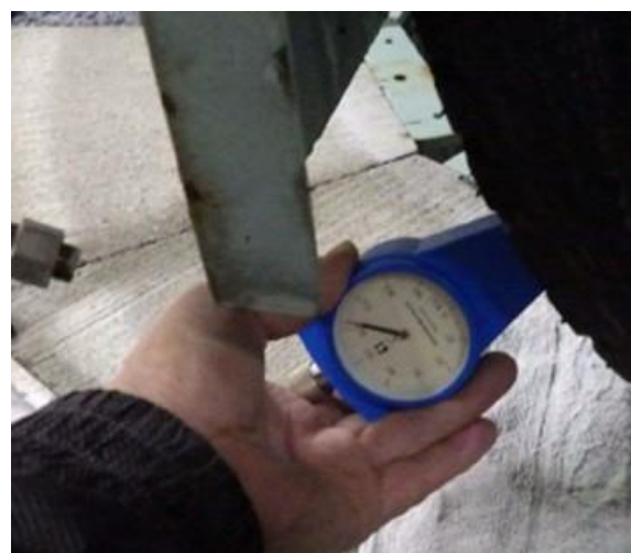
写真-2 ゴム硬度の測定状況
