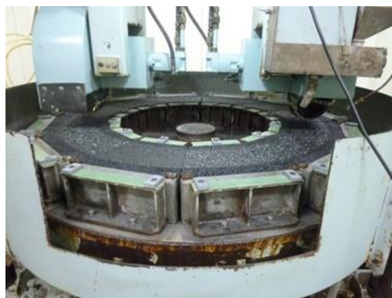
写真-1 ラベリング試験機の外観
