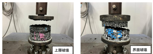
写真 1 乳剤塗布無し(下層温度条件: 左 110℃・右 60℃)
