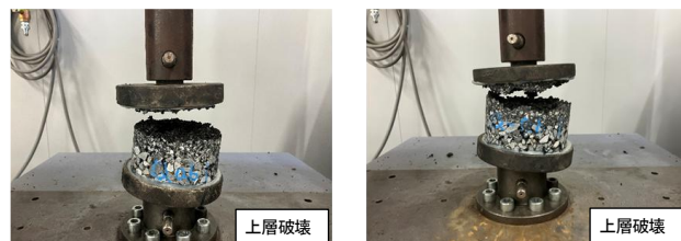
写真4 PKM-TQ 0.6ℓ/m2 (下層温度条件: 左 110℃・右 60℃)
