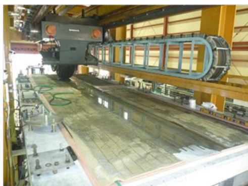
写真-1 輪荷重走行疲労試験の様子 (水張条件)
