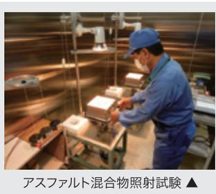
アスファルト混合物照射試験 ▲
