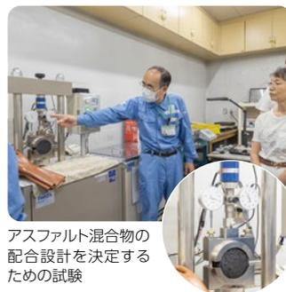
アスファルト混合物の配合設計を決定するための試験
