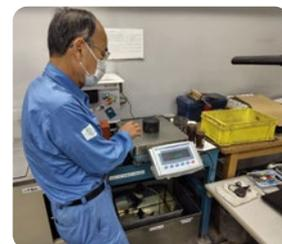
アスファルト混合物の質量を測定し密度を算出
