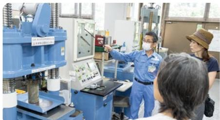
コンクリートの強度が定められた基準に達しているかを確認する試験
