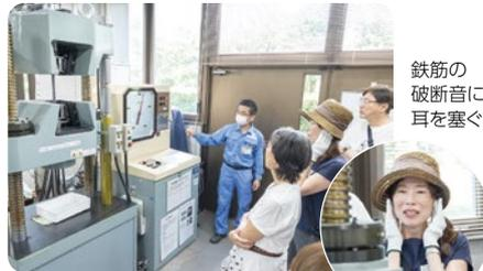
万能試験機で鉄筋に連続的に引張荷重を加える
