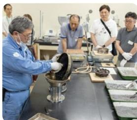
さらに温めたアスファルトを加えて混ぜ突き固め用の金型に移す
