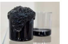
低炭素(中温化)アスファルトの発泡イメージ
