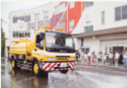
作業中にホコリがたないように水を撒く散水車には、約6500ℓの水が積まれています。
