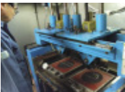
アスファルト混合物の動的安定度試験
