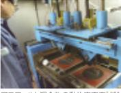
アスファルト混合物の動的安定度試験
