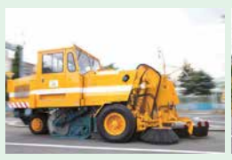
ブラシを使って道路をきれいにしていくロードスーパ―。平均時速は5～6kmというゆっくりとした速度です。
