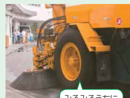
デモンストレーション走行を窓越しに見学。東京の道路清掃は、先行車、散水車、ロードスーパ―、ゴミ運搬車の4台が1チームとなって行っています。
