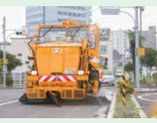
ブラシを使って道路をきれいにしていくロードスーパ―。平均時速は5～6kmというゆっくりとした速度です。
