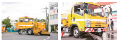
平均時速は5～6kmというゆっくりとした速度で走りながら、ブラシを使って道路をキレイにします。
