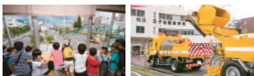
デモンストレーション走行を見学。先行車、散水車、ロードスイーパー、ゴミ運搬車の4台が1チームとなって東京の道路清掃を行っています。
