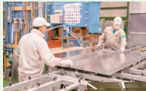
材料のアルミニウムに20センチ間隔で補強材をスポット溶接。2人の息がぴったり合っています。
