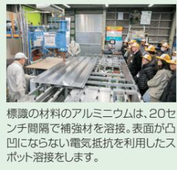
標識の材料のアルミニウムは、20センチ間隔で補強材を溶接。表面が凹凸にならない電気抵抗を利用したスポット溶接をします。
