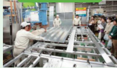
標識の材料のアルミニウムは、20センチ間隔で補強材を溶接。表面が凸凹にならない電気抵抗を利用したスポット溶接をします。
