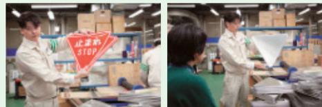
規制標識の厚さは1ミリ。強度を高め危険性を回避するために縁回りを丸めています。
