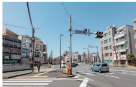
大震災(震度6弱以上)が発生した時の交通規制に対応する、都心部への一般車両の流入を禁止、制御する特殊な信号になっている。防災型信号機で、通常の信号灯の下に信号灯器がもう1つ並んでいる。
