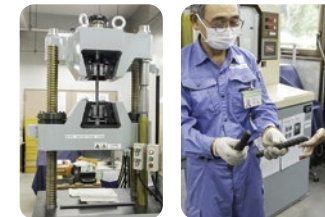
万能試験機で鉄筋 に連続的に引張荷 重を加える
