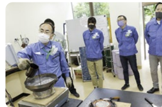
約160度に温めたアスファルトを混合物全 体の5%程入れる
