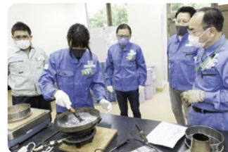
石粉、細目砂、砂利など5種類の材料を鉄鍋 に入れて火にかけ、よく混ぜながら温める
