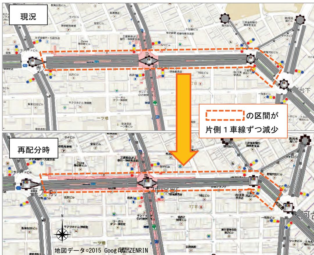
図 3-6 靖国通りの現況の横断構成（上）と再配分時（下）のネットワークの違い
