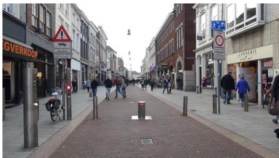
図-2 欧州で利用されているライジングボラード（オランダ，セルトーヘンボス）
