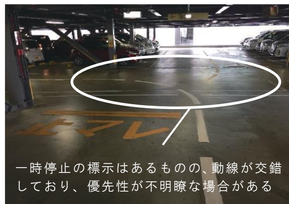
図 4-28 車路の分合流部の優先性の明確化
