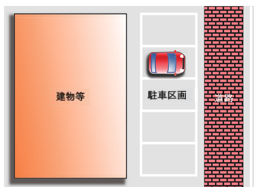
③駐車区画のみで通路部分がない
