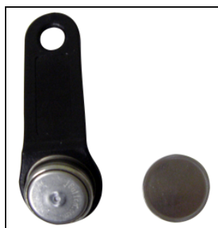
図 13. 温度調査に用いたデータロガー(左:温湿度ロガー、右:温度ロガー)
