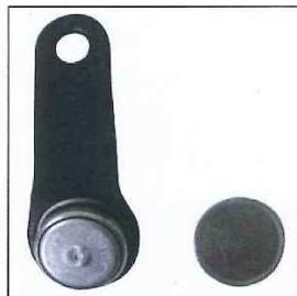
温度調査に用いたデータロガー(左:温湿度ロガー、右:温度ロガー)
