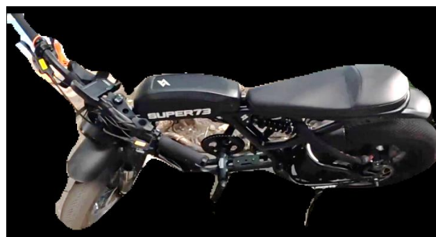
図14 バイクの検知画像の例（ファットバイクをバイクと誤って認識した例）
