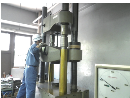
鉄筋の引張試験
