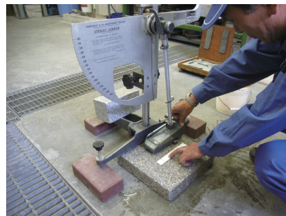
舗装材のすべり抵抗試験
