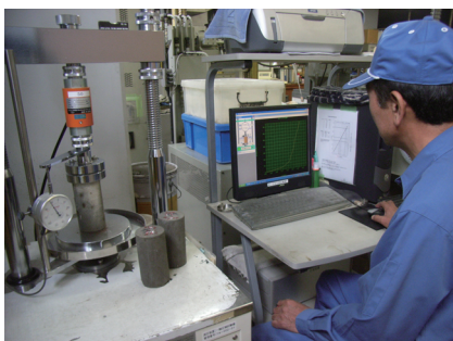
地盤改良土の圧縮試験
