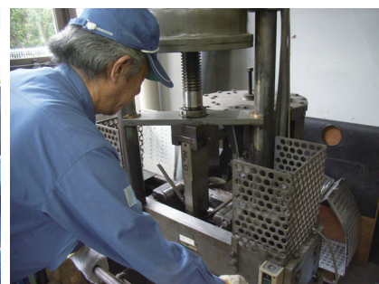
鉄筋の曲げ試験
