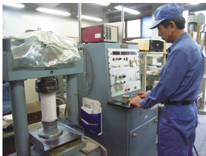
コンクリートの圧縮試験
