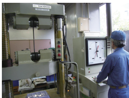
鉄筋の引張試験
