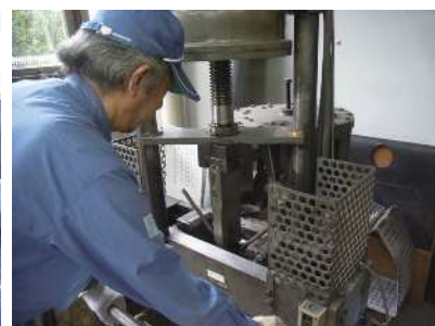
鉄筋の曲げ試験
