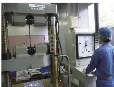
鉄筋の引張試験
