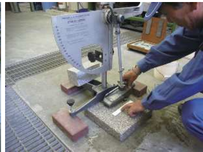
舗装材のすべり抵抗試験
