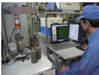
地盤改良土の圧縮試験
