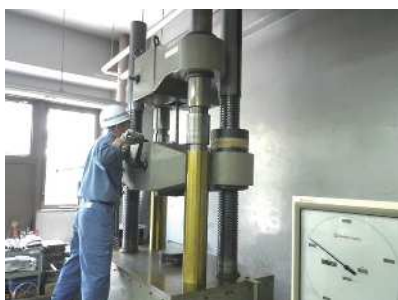
鉄筋の引張試験
