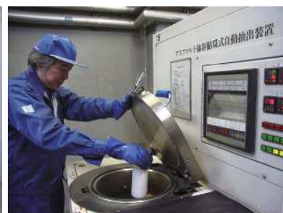
アスファルト抽出試験
