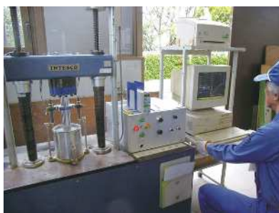
修正CBR試験
