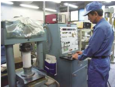
コンクリートの圧縮試験
