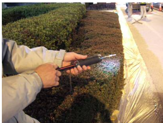
写真-6 MMA 濃度(施工時)測定状況
