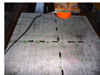
写真-4 BP-4.5S の上面破壊状態
