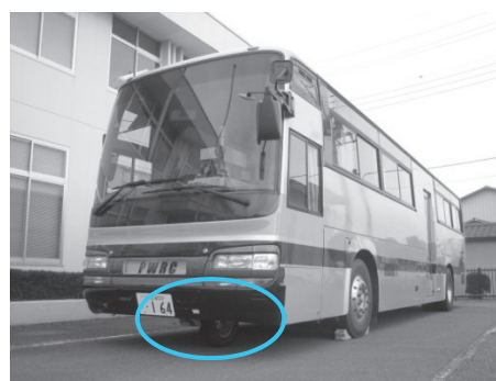
写真-1 すべり抵抗測定車外観
