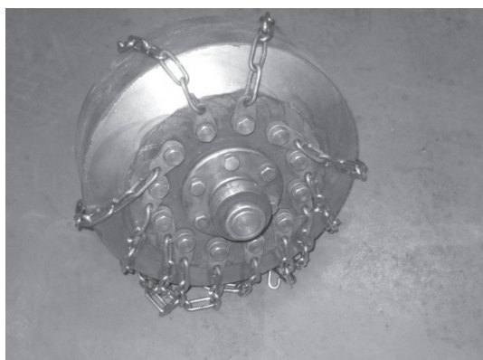
写真-4 チェーン取り付け状況（12本）
