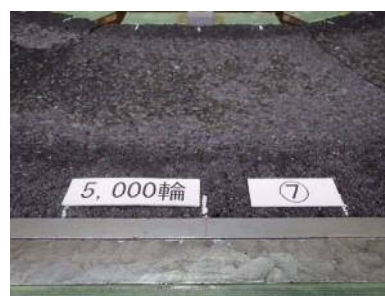
写真-7 破損小・工法 B・5,000 輪後の供試体
