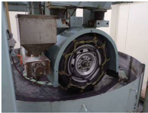
写真-3 回転式ラベリング試験実施状況
