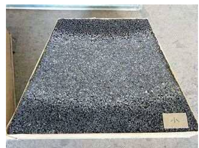
写真-4 破損供試体 (破損小)
