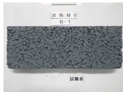
写真-4 遮熱材 B の供試体
