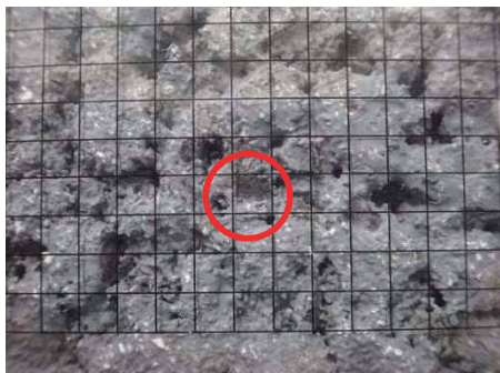
写真-10 目視評価用標本写真(70～80%程度)
