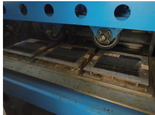
写真-2 ホイールトラッキング試験
