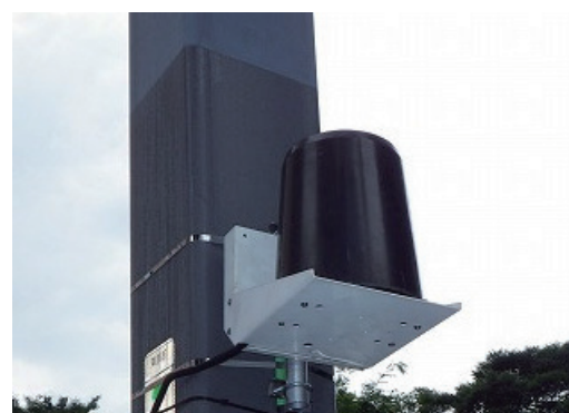
写真-3 雨量測定状況
