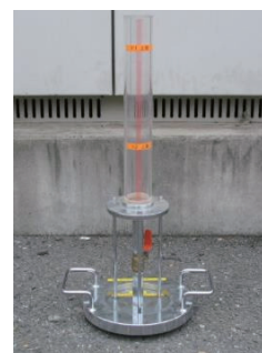
写真-7 現場透水試験器
