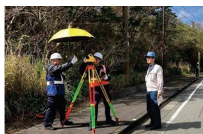
1級水準測量の実施状況
