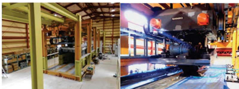
輪荷重走行試験機による疲労実験の状況
