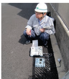
道路の振動調査
